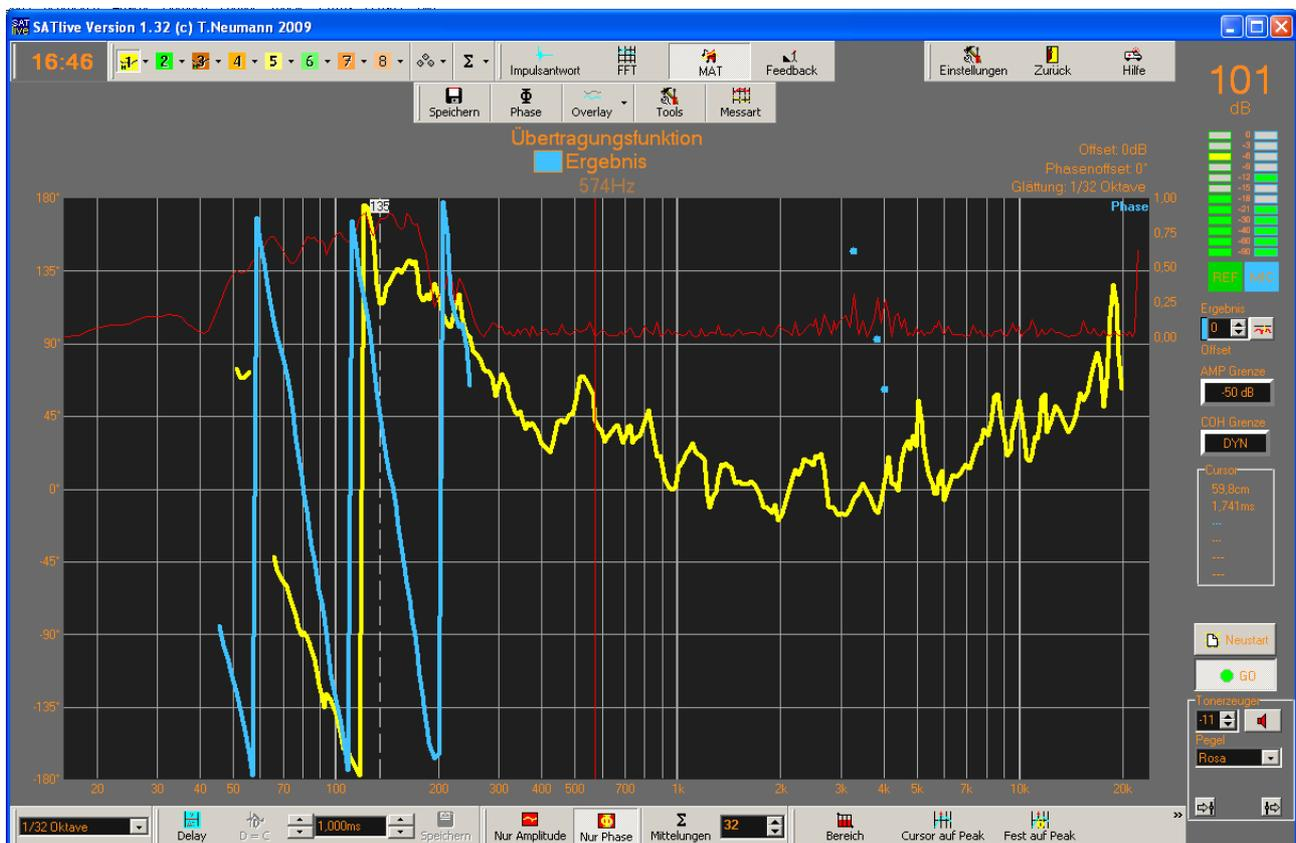
Das Bild zeigt die Ansicht **Nur Phase**. Die Übergangsfrequenz wurde mit einer Markierung<sup>3</sup> versehen, damit der entsprechende Bereich leichter zu erkennen ist. Diese Anzeige erleichtert die Anpassung der Steigungen der Phasenkurven durch ein externes Delay speziell auf Computern mit kleinerer Anzeige durch eine vergrößerte Darstellung.
